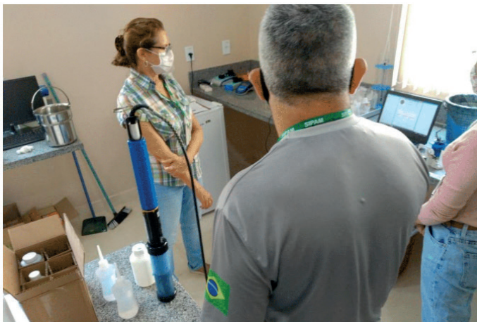
Figura 02- Calibração da sonda TROLL 9500, no laboratório da SEDAM-RO, com parceria dos profissionais do SIPAM.
