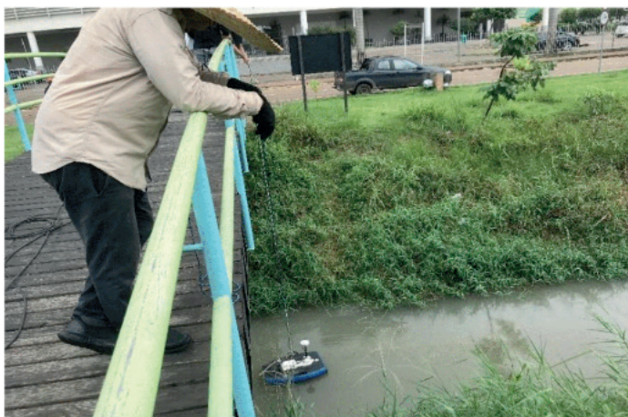
Figura 03 – Utilização do perfilador hidroacústico.
