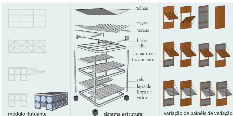
Figura 9 – Imagens do projeto Navegar – porto, oficina de barcos e memória: módulo flutuante (esquerda), perspectiva explodida da estrutura (centro) e variação modular das vedações e aberturas
