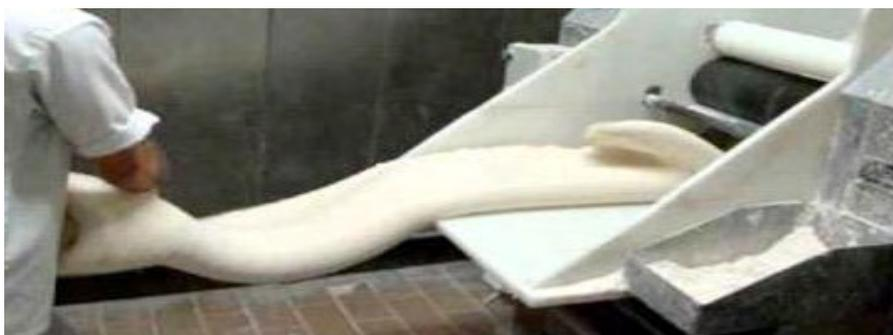
Figura 2 – Representação de cilindragem da manta de massa.
