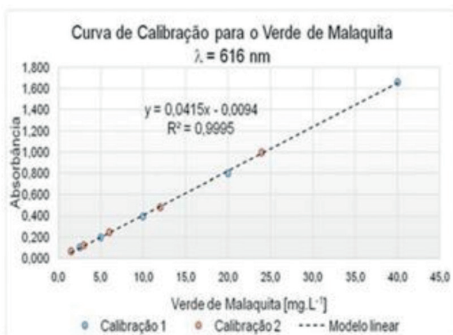
Figura 2. Curva de calibração para determinação da concentração de Verde de Malaquita em solução
