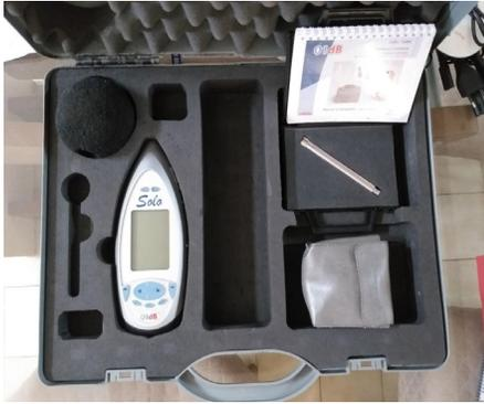
Figura 7 -Medidor de Nível de Pressão Sonora.
