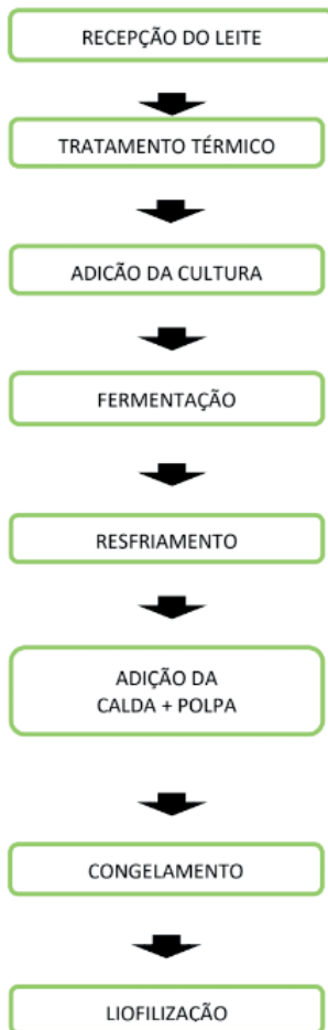
Fluxograma 1 – fluxograma da formulação do leite fermentado liofilizado com sabor de bacuri
