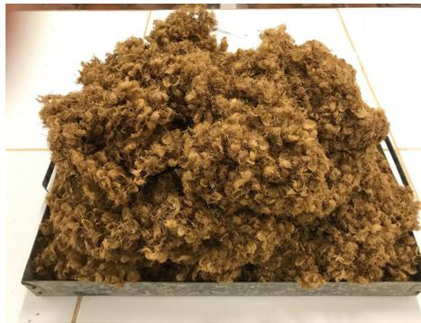
Figura 2 - Fibras retiradas do caroço de açai.
