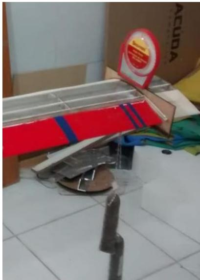
Figura 3 - Ensaio do eixo elástico.
