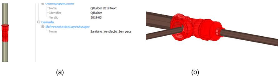
Figura 4 – (a) Conexão sem peça associada; (b) Conexão com geometria incorreta para a tubulação.
