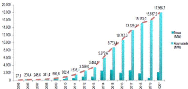
Figura 2 – Evolução da capacidade instalada (Adaptado de ABEEÓLICA. (2017, p.5)).
