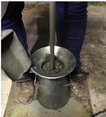
Figura 3 - Ensaio abatimento tronco de cone.
