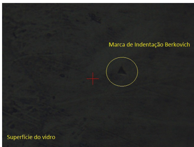
Figura 2: Marca microscópica na amostra devido indentação com cabeçote Berkovich.
