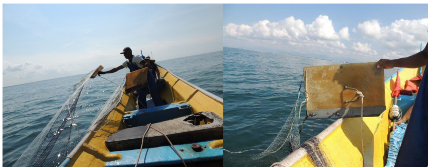
Figura 2 - Pranchas com sapatas metálicas de rede de arrasto de manga redonda
