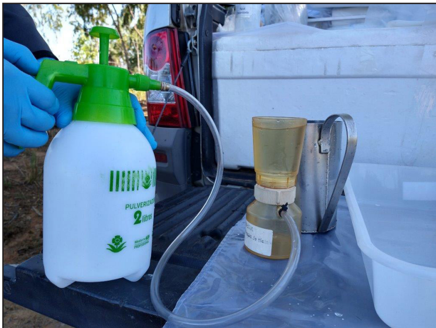
Figura 29 - Filtração de água para análises de elementos dissolvidos
