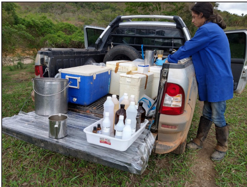
Figura 30 - Armazenamento de amostras de águas e sedimentos em campo para realização de análise laboratoriais
