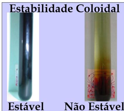
Figura 3. Fotografia de nanofluidos aquosos de  $\text{Cu}_{(2-x)}\text{S}$  revestidos com TGA que apresentaram estabilidade coloidal (superior a 24 horas) a esquerda e baixa estabilidade coloidal (inferior a 1 hora) a direita.
