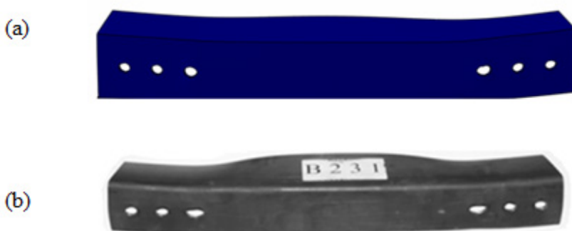
Figura 8 - Deformação numérica (a) e experimental (b) da cantoneira B231 no momento de carga última.
