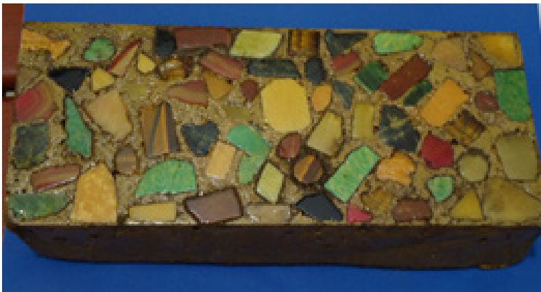
Figura 6: Concreto polido e envernizado (1ª tentativa).
