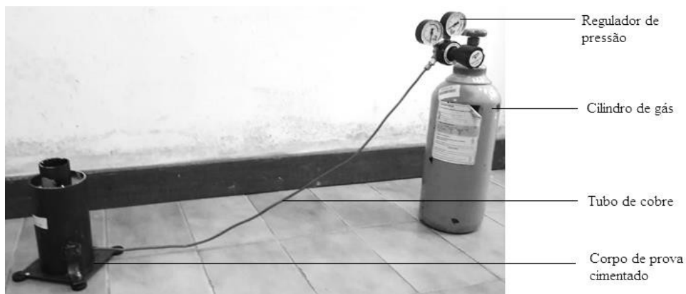
Figura 20: Vista lateral do corpo de prova com migração de gás.
