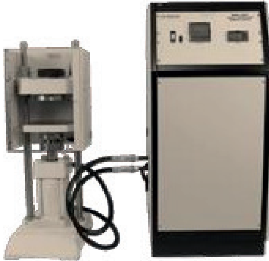
Figura 11: Prensa de Chandler
