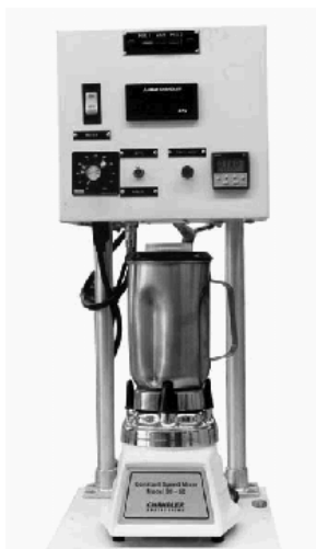
Figura 6 Misturador de Palhetas
