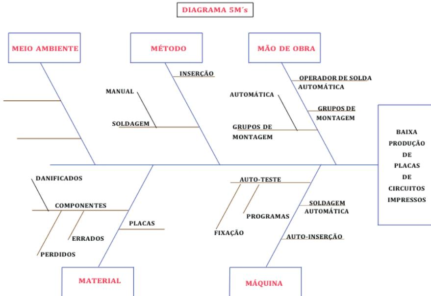
Figura 4.3: Modelo de análise de causa e efeito - exemplo de baixa produção de placas de circuitos impressos
