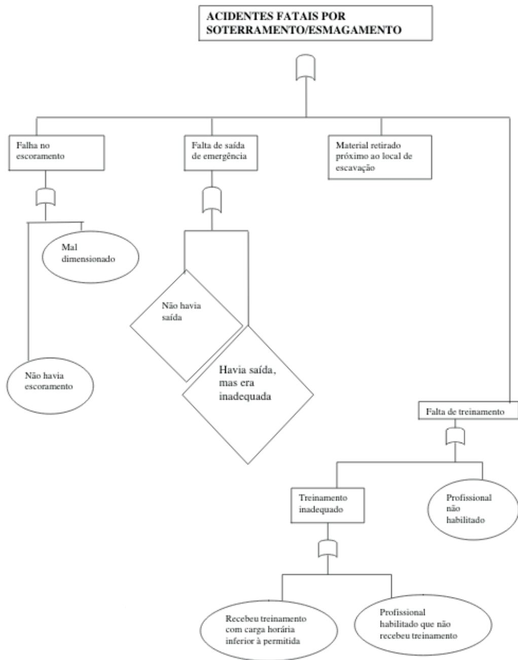
Figura 5.7: Análise de modo de falha e efeito para acidentes fatais por soterramento/ esmagamento
