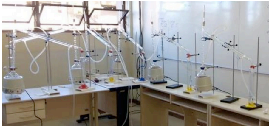
Figura 02 - Sistemas de destilação fracionada utilizados
