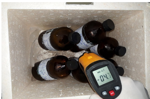
Figura 3: Armazenamento das amostras de água em frascos âmbar com refrigeração.
