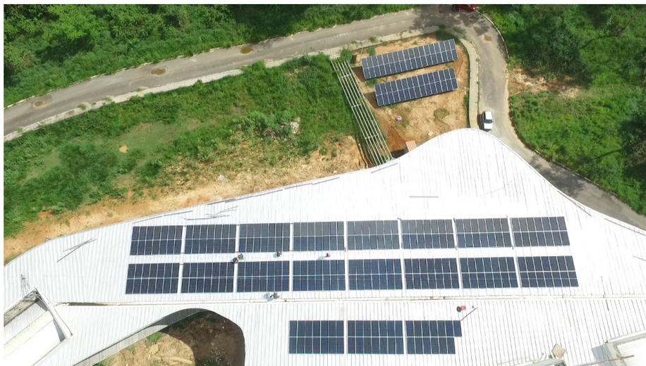
Figura 2: Geradores de 24,09 kWp (solo) e 96,36 kWp (cobertura).
