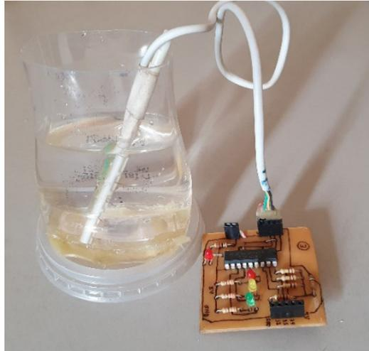
Figura 4 – Sensor e o módulo montados na placa pci.
