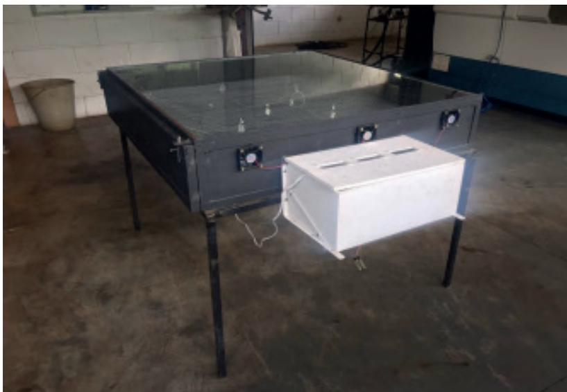
Figura 1 - Secador solar plano de exposição direta
