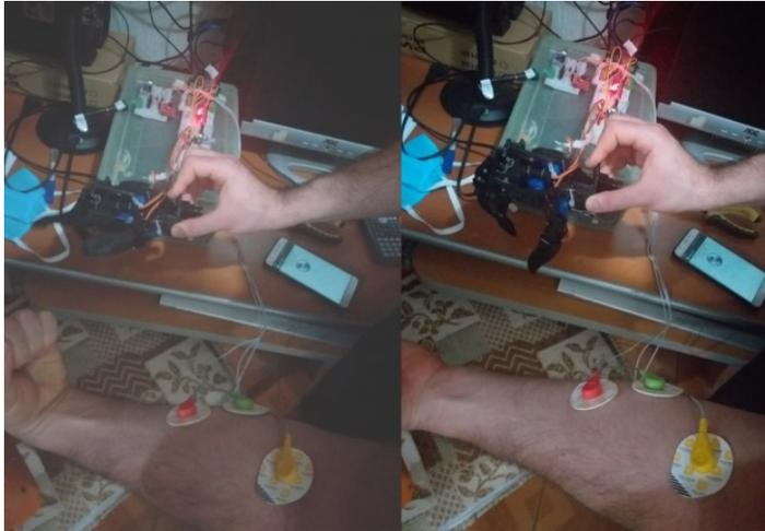
Figura 8 – Eletrodos fixados e acionamento da posição pinçar.
