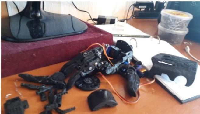
Figura 5 – Montagem da mão mecânica.
