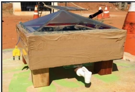
Figura 7: Destilador solar ajustado (Oliveira, 2018).
