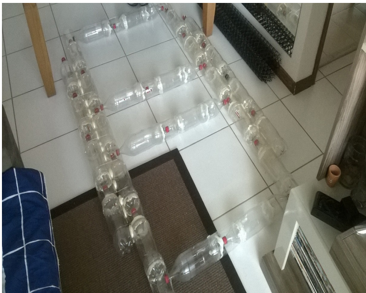
Figura 4 - Montagem da estrutura de uma ilha flutuante.
