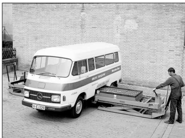
Figura 3: Furgão elétrico modelo LE306 produzido pela montadora Mercedes Benz na Alemanha, com dispositivo de troca rápida do banco de baterias. Larmine (2003).
