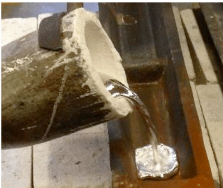
Figura 1. Procedimento de vazamento do material fundido a partir da sucata de alumínio utilizado no trabalho.
