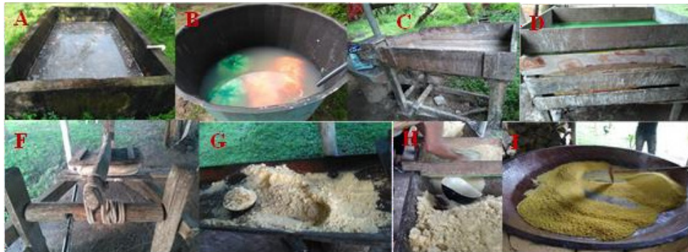
Figura 4: Processo para a produção da farinha, (A) o tanque de alvenarias com a mandioca e água, (B) a caixa d'água com massa da mandioca em saca, (C) a caixa de madeira que fica o moedor, (D) o crivo local de seleção da massa, (F) a prensa, (G) massa na maceira passando pelo moedor, (H) a peneiragem e a (I) o forno com farinha.
