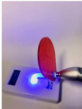
Figura 7. PW sendo aferido no RD-7 com a película de PVC.
