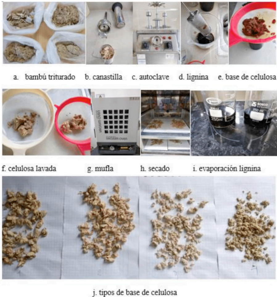
Figura 2. Proceso de obtención de base de celulosa de bambú, en relación al tamaño de partícula
