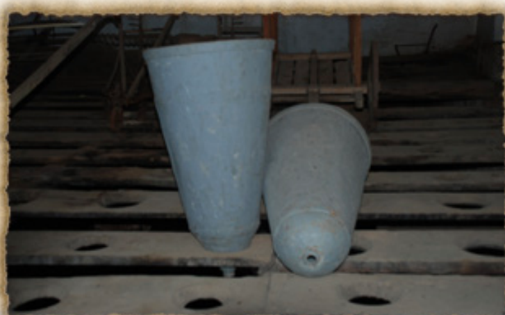
Figura 7: Interior da Casa de Purgar, ilustrando as formas de cristalização nas quais o melaço era convertido em açúcar. Ao final do processo, o melaço escorria para o reservatório logo abaixo e o açúcar cristalizado era retirado das formas.
