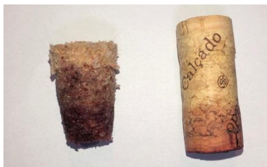
Figura 4- Rolhas após 30 dias utilização em garrafa
