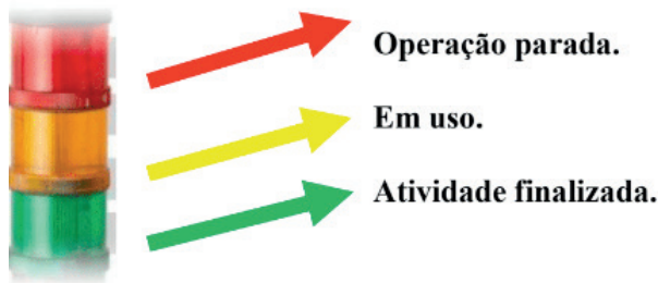
Figura 2 – Configuração da iluminação do sistema Andon
