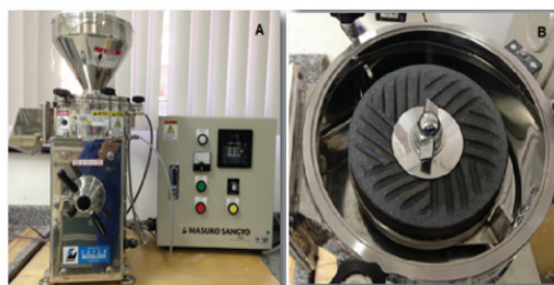
Figura 2. (A) Moinho Super Masscolloider MKCA6-2J (Masuko Sangyo). (B) Pedra de moagem inferior móvel do Moinho Super Masscolloider.
