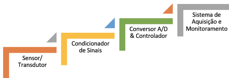
Figura 2.1. Estrutura do Sistema de Aquisição de Dados
