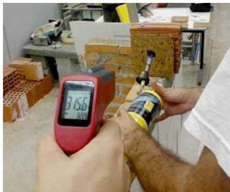
Figura 10 – Ensaio de Antichamas
