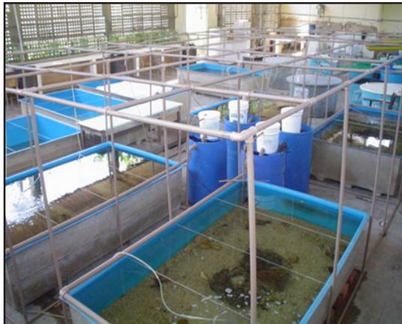
Figura 12- Sistemas de recirculação para manutenção de reprodutores de espécies do gênero Panulirus .
