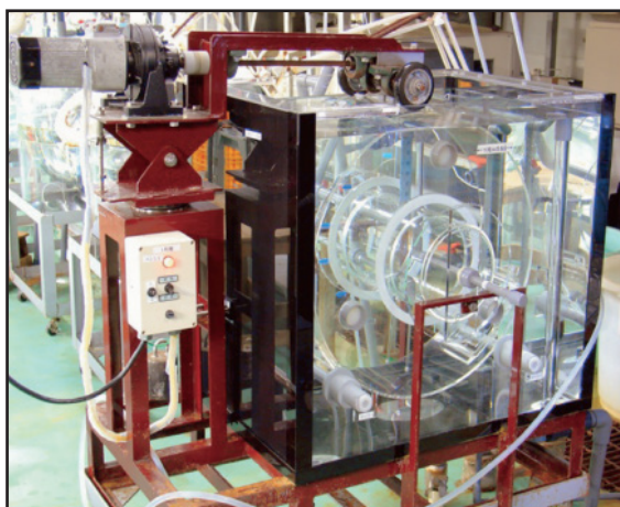
Figura 7- Sistema de cultivo rotativo vertical ( VRR System ), para cultivo de filosomas da espécie Panulirus japonicus .
