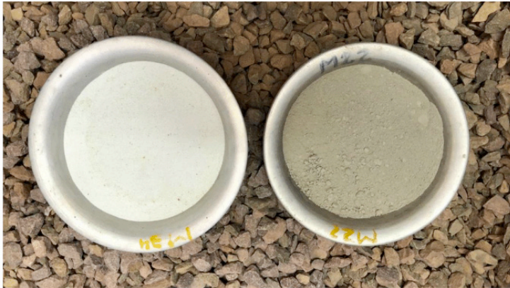
Figura 1 – Pó de vidro e cimento utilizados como aglomerante.
