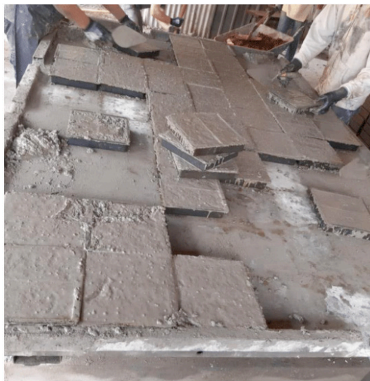
Figura 2 – Amostragem em preparo para o adensamento sob mesa vibratória.
