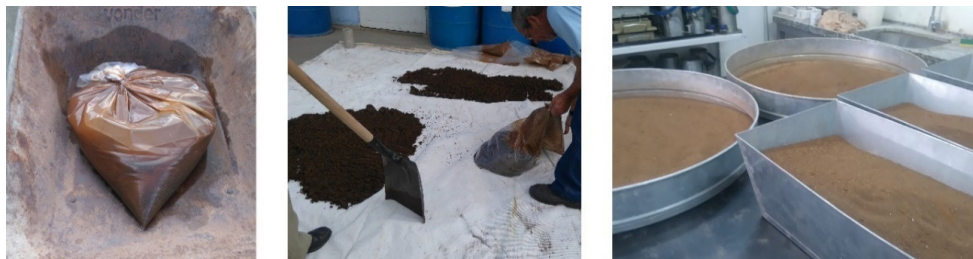
Figura 2 - Recebimento, quarteamento e secagem do rejeito
