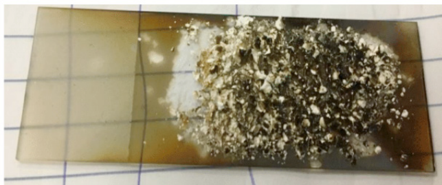
Figura 1: Deposição de Fe sobre o \text{Eu}_2\text{O}_3 . Observa-se no vidro um filme de Óxido de Ferro após o tratamento no reator.
