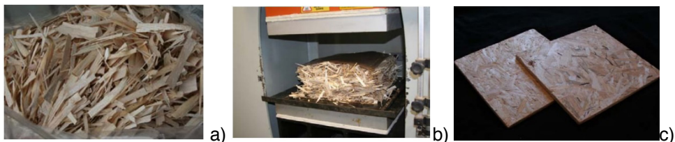
Figura 3 Produção do painel OSB a) Strands, b) Colchão de partículas, c) Painel OSB
