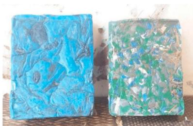
Figura 8 - PEAD após 8h na prensa
