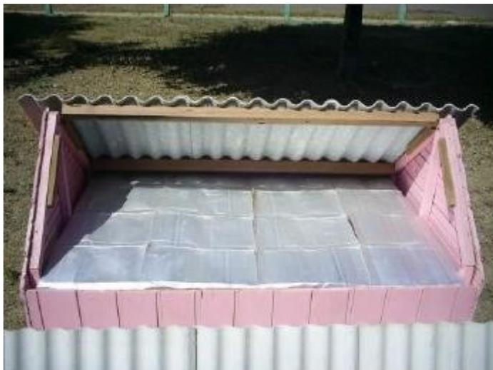
Figura 4 – Maquete de madeira onde foram realizados os testes utilizando as embalagens Tetra Pak® como subcobertura
