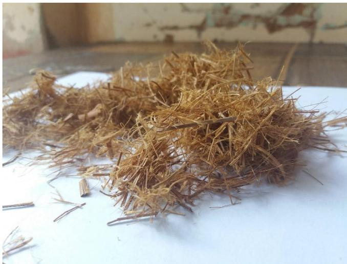
Figura 4 -Fibras de bambu extraídas
