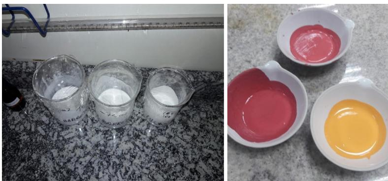
Figura 1. Tintas branca e coloridas, obtidas após a mistura dos pigmentos na tinta branca.
