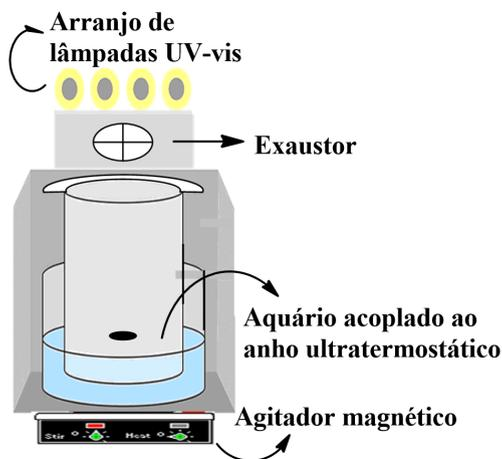
Figura 2: Reator fotocatalítico acoplada ao banho ultratermostático.
