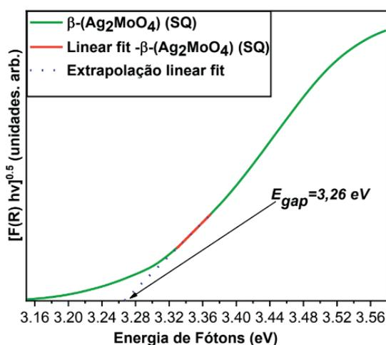
Figura 5: Espectro de UV-Vis por Reflectância difusa para a amostra dos microcristais  $\beta$ -( $Ag_2MoO_4$ ) sintetizados pelo método sonoquímico (SQ) a 70 °C por 3 horas com 200 mL de  $H_2O$ .
