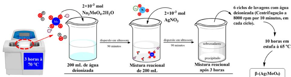
Figura 1: Esquema representativo da rota de síntese dos microcristais de  $\beta\text{-(Ag}_2\text{MoO}_4)$ .
