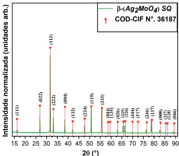
Figura 3: Padrões de DRX normalizados para os cristais puros de  $\beta$ -( $\text{Ag}_2\text{MoO}_4$ ) sintetizados pelo método sonoquímico (SQ) a 70 °C por 3 horas com 200 mL de  $\text{H}_2\text{O}$ . As linhas verticais (I) indicam as respectivas posições e intensidades encontradas na placa COD-CIF n° 36187 correspondente à fase beta ( $\beta$ ) do  $\text{Ag}_2\text{MoO}_4$  e estrutura cúbica.
