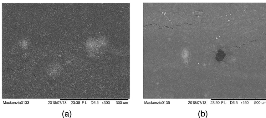
Figura 5. (a) Tinta com pigmento cádmio sem realização do teste *Cold Check*;
