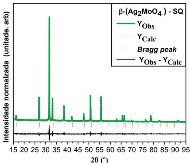
Figura 4: Gráfico de refinamento de Rietveld dos cristais de  $\beta$ -( $\text{Ag}_2\text{MoO}_4$ ) sintetizado pelo método sonoquímico (SQ) a 70 °C por 3 horas com 200 mL de  $\text{H}_2\text{O}$ . As linhas verticais (|) indicam as respectivas posições e intensidades encontradas na placa COD-CIF nº 36187 correspondente à fase beta ( $\beta$ ) do  $\text{Ag}_2\text{MoO}_4$  e estrutura cúbica.
