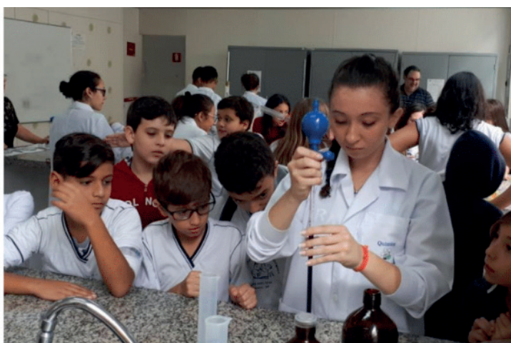
Figura 3: Aluna da Etec Trajano Camargo demonstrando, no Laboratório de Química, a técnica de pipetagem utilizada para medida de volume de líquidos.
