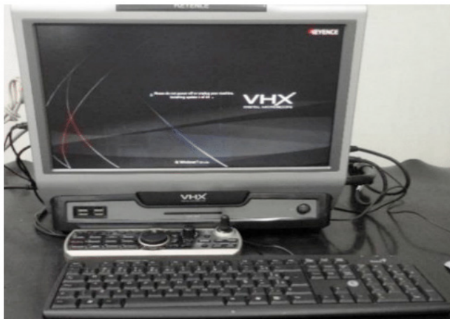
Figura 3. Microscópio digital metalográfico, VHX-700: monitor, teclado e console de controle foco e ampliação de imagens.
