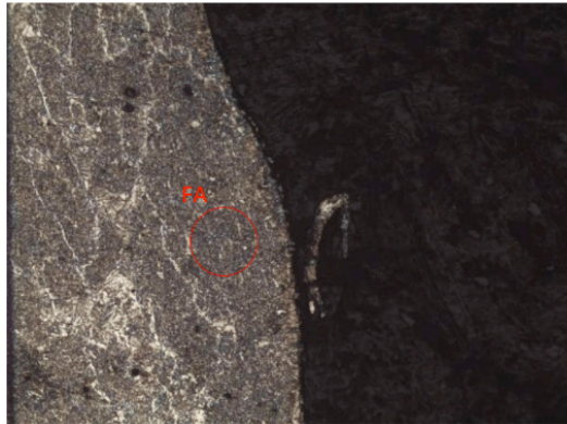
Figura 11. Metal de adição: ER70S-6, Ataque Nital 2%. Aumento 500X.
