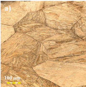
Figura 14. Micrografia Confocal da liga Cu-14Al-4Ni betatizada, com TCP de 2 h, com a) 100 e b) 500 ciclos.
