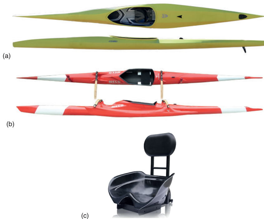
Figura 3- Embarcações oficiais da Paracanoagem. (a) Caique; (b) Canoa Va'a; (c) Banco adaptado
