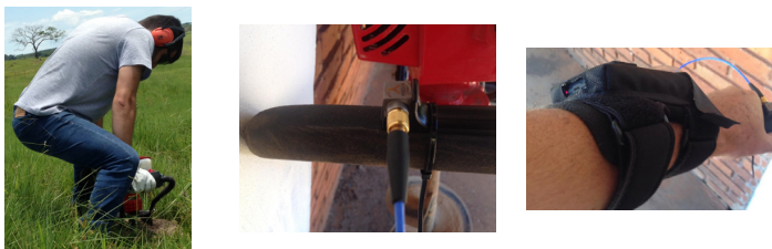
Figura 1: montagem do sensor de vibração
