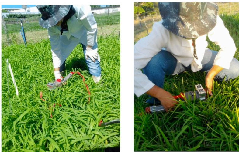
Figura 4 - Obtenção de dados utilizando o IRGA
