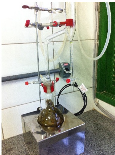
Figura 1: Sistema de hidrodestilação por equipamento clewenger.
