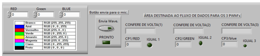
Figura 8 - Área da determinação da cor do LED-RGB e envio de dados para PWM.
