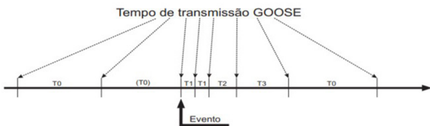
Figura 3. Mecanismo de retransmissão GOOSE (OLIVEIRA; LOPES, 2018).
