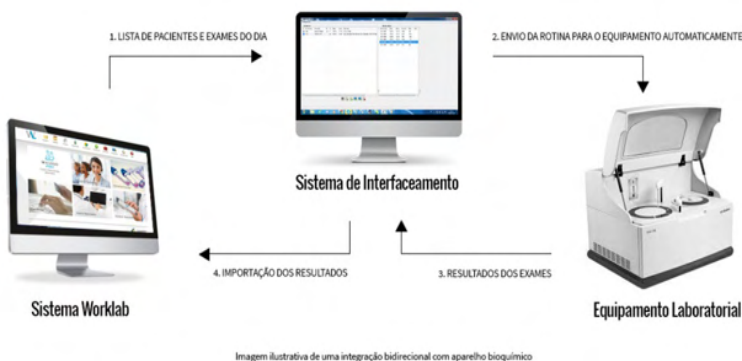
Figura 5: Demonstração do interfaceamento dos softwares com aparelhos de análises.
