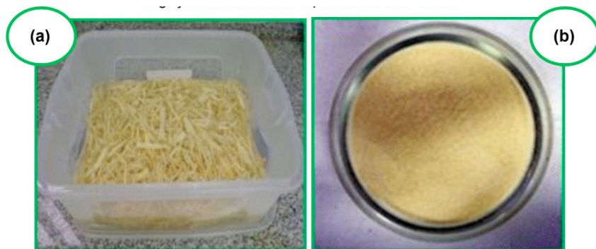
Figura 3. (a) Fibras do bagaço de cana-de-açúcar imersas em banho de água destilada; (b) Bagaço de cana moído e peneirado a 30 mesh .
