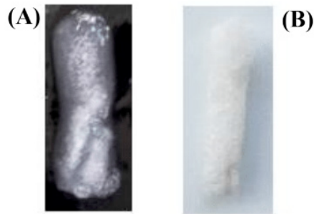
Figura 8. Imagem da estrutura porosa após descongelamento (A) e após liofilização (B)
