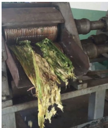
Figura 1. Moagem da cana-de-açúcar em uma indústria de produção de aguardente localizado na cidade de Abaíra - BA.
