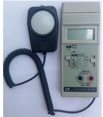
Figura 7 – Luxímetro usado para as medições de iluminância.
