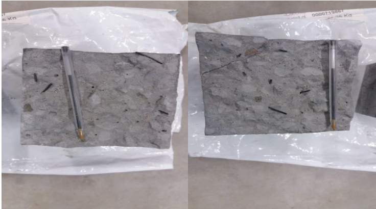
Figura 5 e 6 – Corpos de prova pós rompimento do compósito pelo ensaio de tração na flexão
