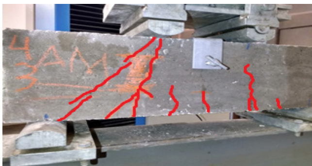
Figura 30 – V04–C fissuras após o ensaio.
