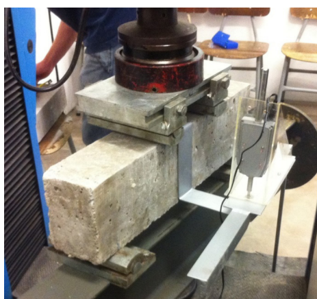
Figura 14 – Ensaio da viga vista dos fundos.
