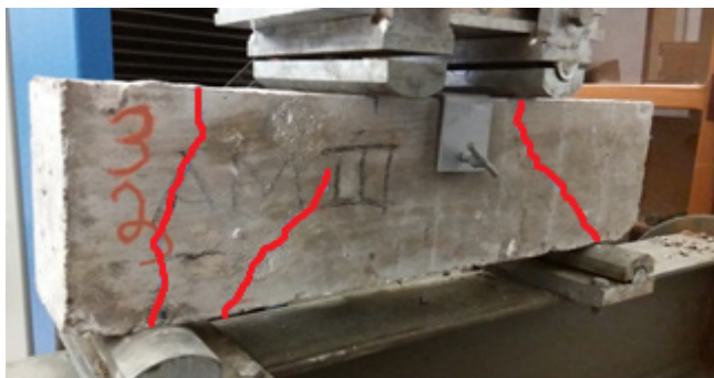
Figura 26 – V03–C fissuras após o ensaio.
