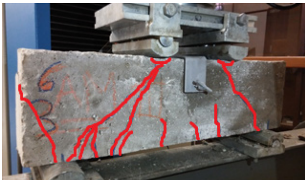
Figura 38 – V06–C fissuras após o ensaio.
