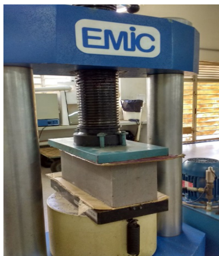
Figura 12 – Ensaio de resistência à compressão dos blocos de concreto.
