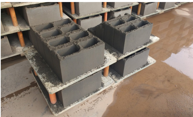
Figura 11 – Blocos de concreto moldados com a adição da CBCA1
