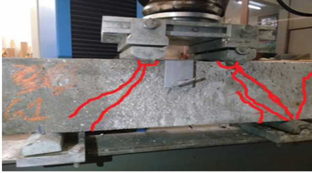
Figura 36 – V06–A fissuras após o ensaio.
