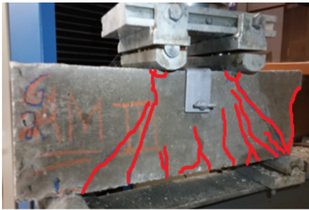
Figura 37 – V06–B fissuras após o ensaio.
