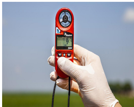
Figura 10. Aparelho para medir a velocidade do vento (termo-higro-anemômetro).
