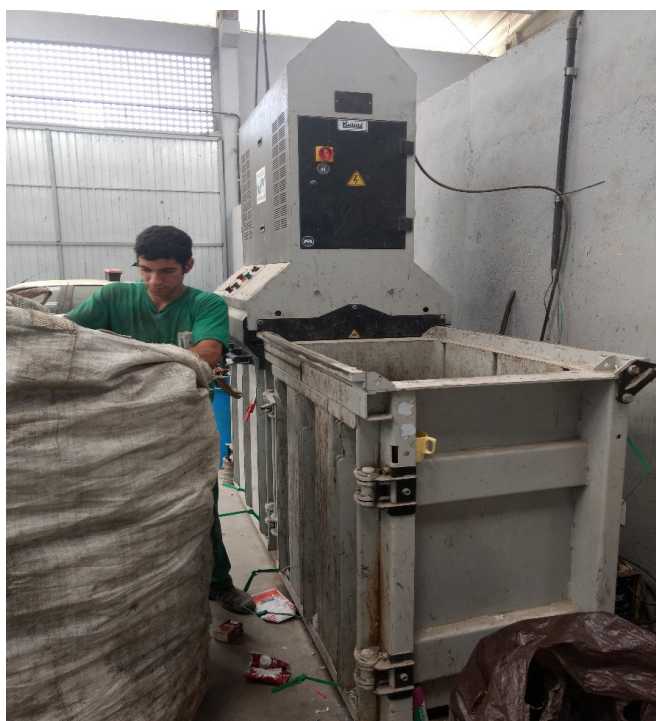
FIGURA 4 – PRENSA UTILIZADA PARA COMPACTAÇÃO DE MATERIAIS (AMAGEM)
