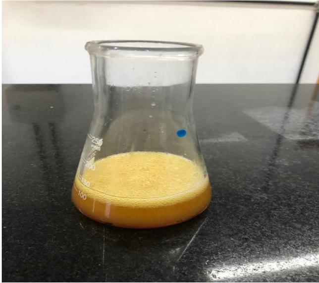
Figura 2: Biodiesel resultante da prática laboratorial na monitoria.
