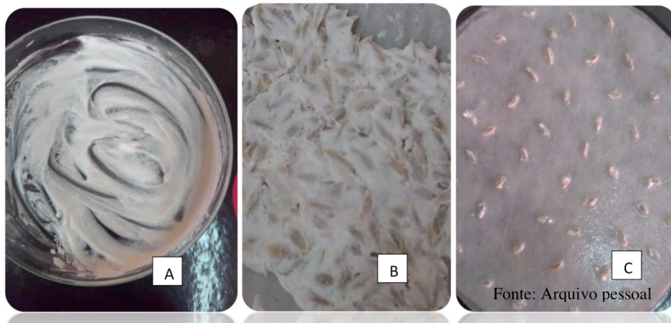
Figura 1: Processo de revestimento das sementes de alface. Esquema (A) talco farmacêutico impregnado com o adesivo, (B) sementes de alface revestidas, (C) sementes revestidas colocadas uniformemente na placa de Petri.
