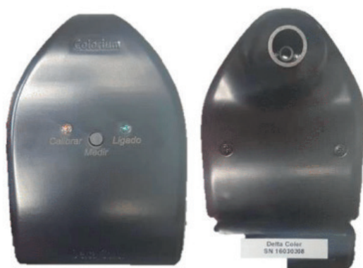
Figura 5 – Colorímetro Delta Color.
