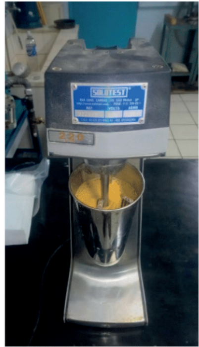
Figura 21 – Mistura de solo e defloculante em misturador automático.
