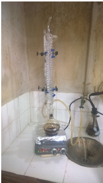
Figura 11 – Sistema de refluxo aplicado à mistura de lignina e resíduo
