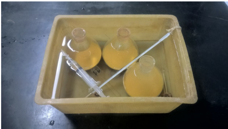
Figura 26 – Homogeneização de temperatura no ensaio de massa específica dos grãos
