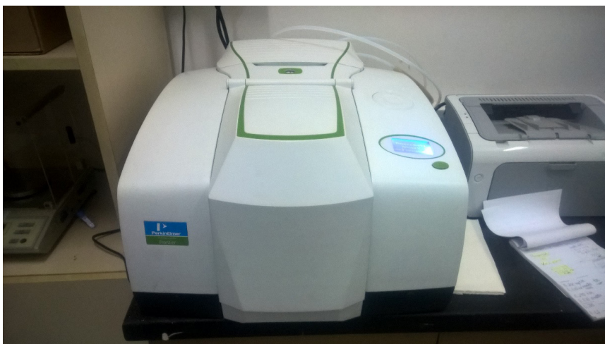
Figura 16 – Equipamento de FTIR da marca PerkinElmer, modelo Frontier.
