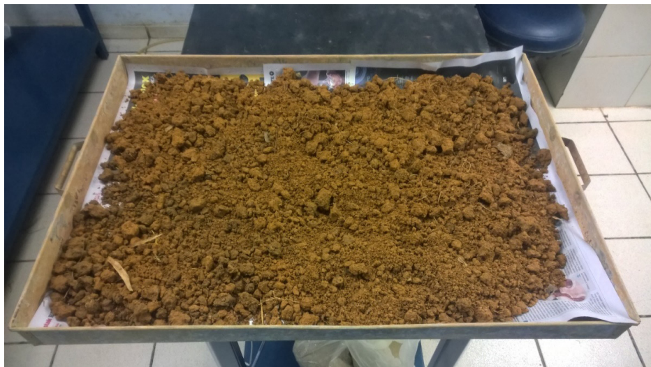
Figura 18 – Solo após secagem em estufa, a 50 °C, durante 24h.
