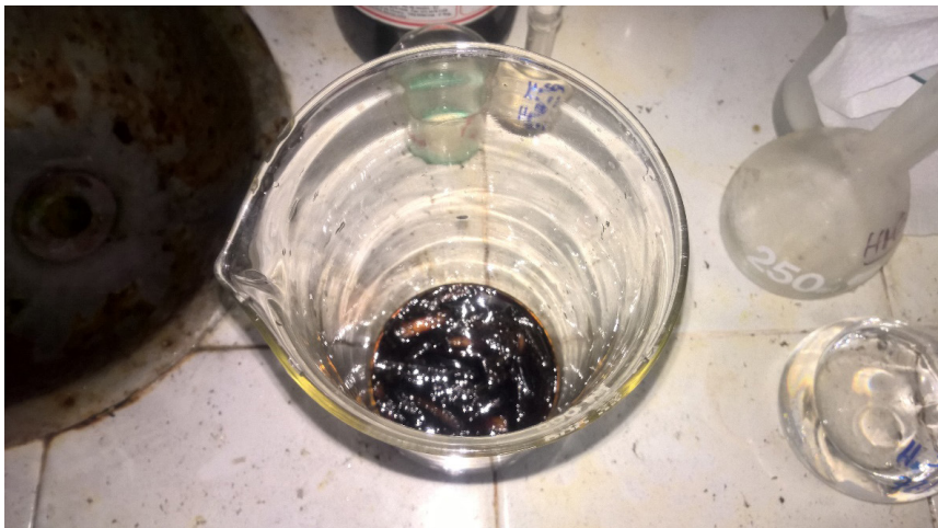
Figura 7 – Bagaço livre de extrativos reagindo com ácido sulfúrico, em vista superior
