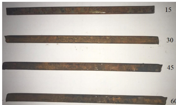
Figura 3: Corrosão em água destilada
