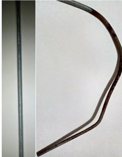
Figura 6 – Resultado do antes e depois do metal de sacrifício.
