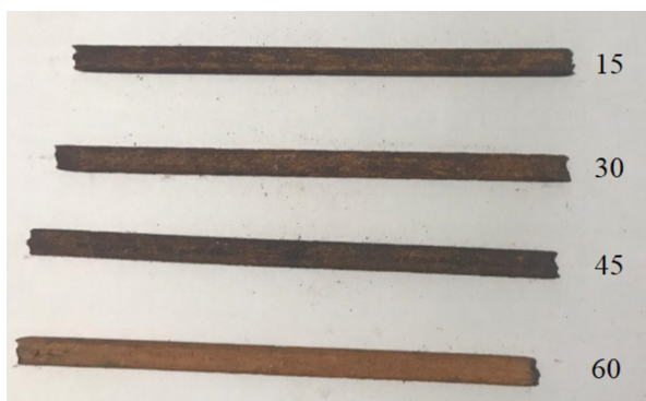
Figura 1: Corrosão em meio ácido.
