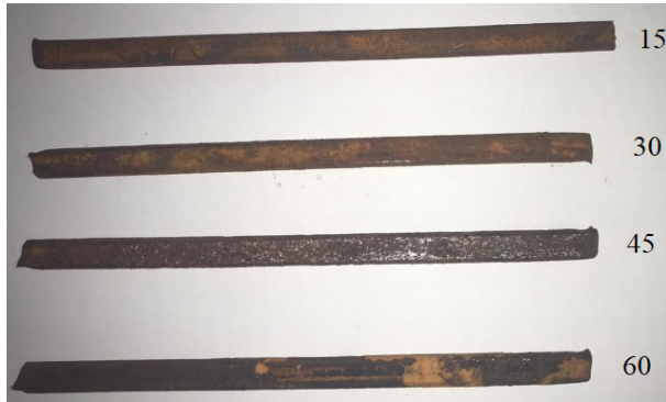
Figura 2: Corrosão em meio ácido.
