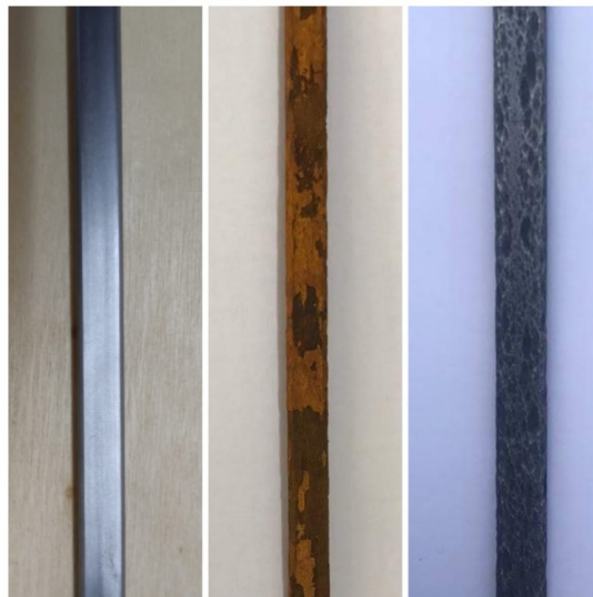
Figura 5 – Resultado da ação corrosiva da solução ácida e o tratamento por eletrólise.
