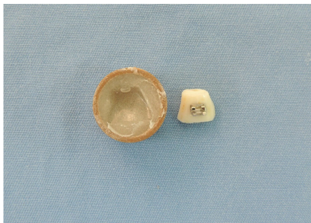
Figura 11 - Dente descolado do corpo de prova
