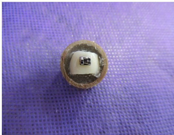
Figura 7 - Corpo de prova após colagem do bráquete.
