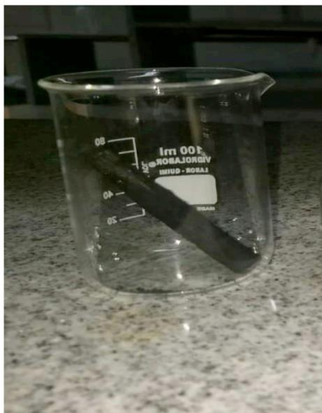
Figura 1- Eletrodo de gráfito extraído da pilha comum
