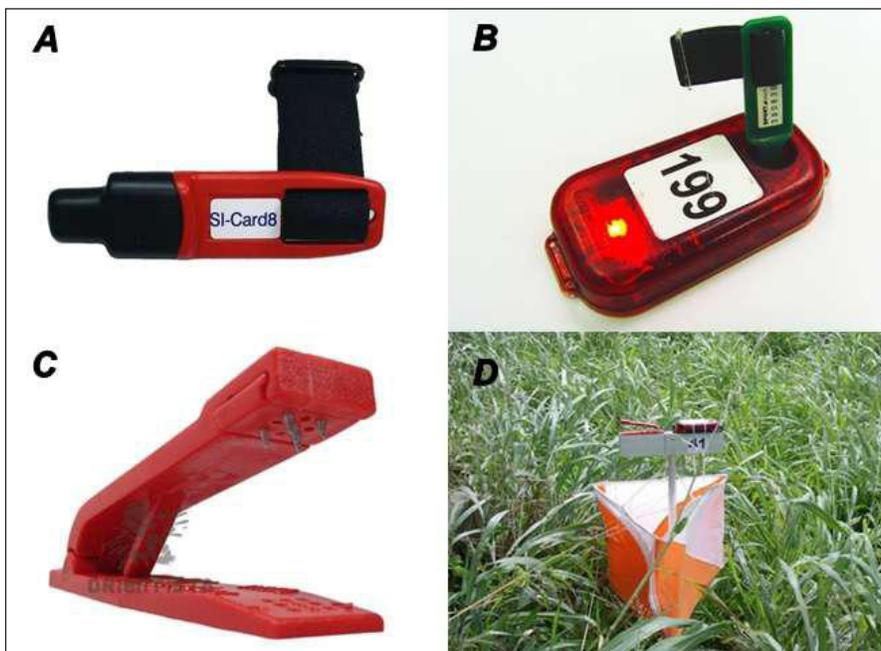
Figura 3 - A) Si-Card; B) Base Eletrônica; C) Picotador; D) Prisma (ponto de controle)
